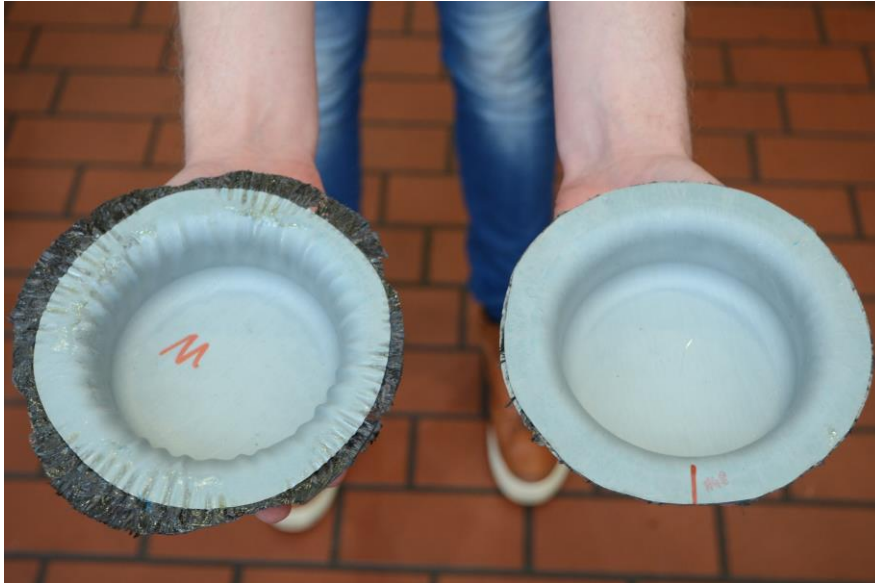
Fig. 3 Links: umgeformter Hybridverbund ohne gesonderte Maßnahmen, Rechts: Umformergebnis eines hybriden Mehrschichtverbunds mit HyOpt Technologie vor dem Besäumen (© LUF, Universität Paderborn)
