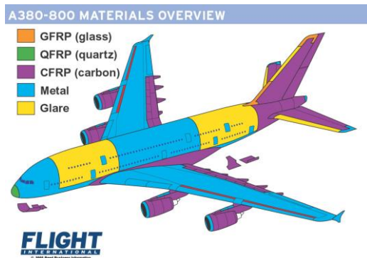
Fig. 1 Einsatz von Glare (gelb) im Rumpfbereich des Airbus A380, aus [1]
